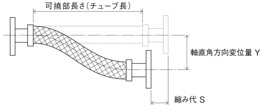
可撓部長さ(チューブ長)に対する軸直角方向変位量の目安
