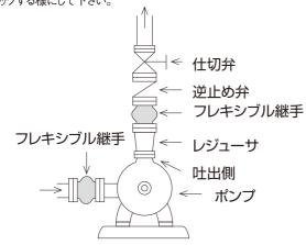
② 製品は、伸張・圧縮・偏芯・角変位など取付時寸法許容値内に納まるように取付して下さい。
